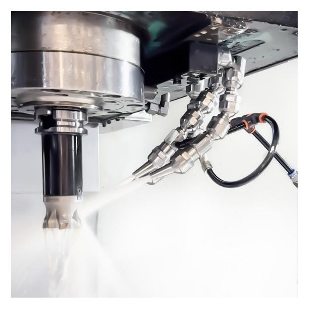
金属切削应用通常使用冷却剂(乳化液或油)来润滑和冷却刀具刃。更好地冷却刀具刃可提高表面质量,延长刀具寿命。
